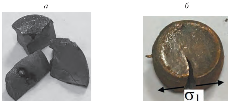
Рис. 3.25. Характер разрушения нанокристаллического бериллия при испытаниях на сжатие на комплексе Gleeble-3800 при 20 (а) и 800 °С (б)
