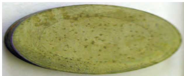
Рис. 3.38. Образец бериллия без признаков разрушения, полученный по оптимизированной технологии прокатки
