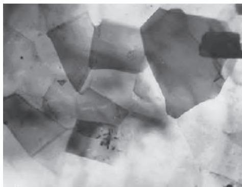
Рис. 1.13. Субструктура гидроэкструдированного бериллия ( \times 7000 раз) со степенью обжатия 92 % при 350 °С [70]
