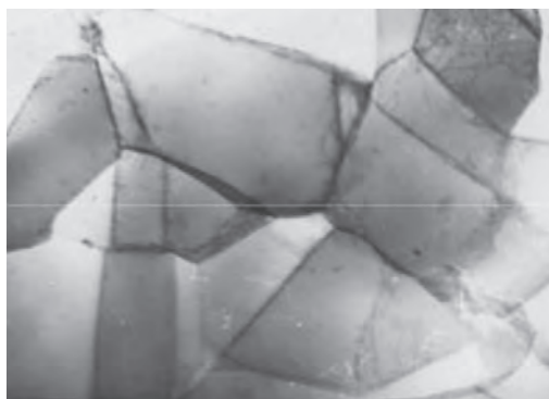
Рис. 1.11. ПЭМ-изображение субструктуры бериллия после горячей прокатки при 870 °С со степенью деформации 80 %. ПЭМ — просвечивающая электронная микроскопия
