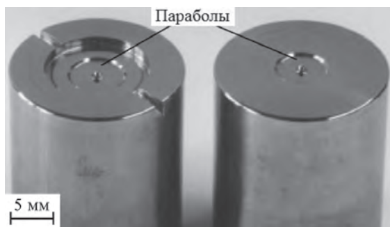
Рис. 3.46. Инструмент для прессования параболических линз из поликарбоната [148]
