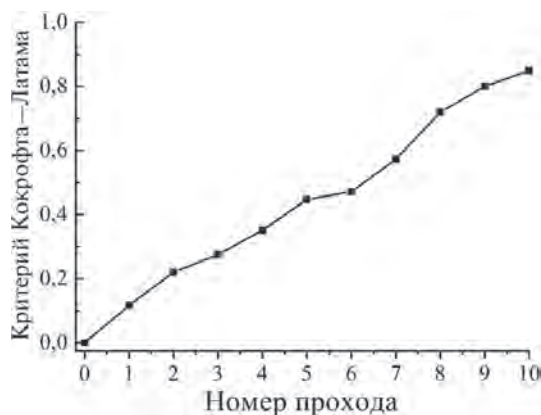
Рис. 3.35. Рассчитанные значения модифицированного критерия Кокрофта—Латама при многопроходной прокатке бериллия в контейнерах из никеля при 400 °С с относительным обжатием за проход 15 % ( C_{\text{К—Л}}^{\text{пред}} = 0,4, 1,4 \text{ и } 1,9 соответственно для нанокристаллического, дистиллированного и технического бериллия)
