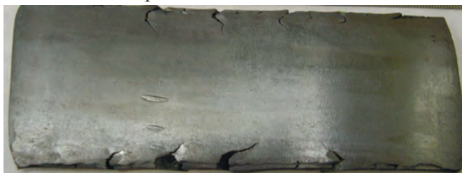
Рис. 3.36. Характер разрушения стального контейнера при теплой прокатке за несколько проходов при накоплении упругости
