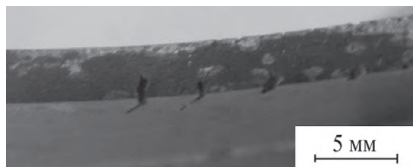
Рис. 3.32. Разрушение технического бериллия во 2-м проходе при тепловой прокатке (400 °C) с обжатием 15 %
