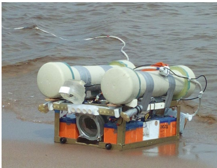
Рис. 5.1.1 – Внешний вид ТНПА Limnoscout 230
