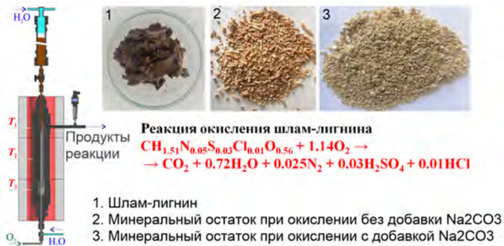
Рисунок 53 – Одностадийный способ полной утилизации отходов целлюлозно-бумажной промышленности с добавкой \text{Na}_2\text{CO}_3
