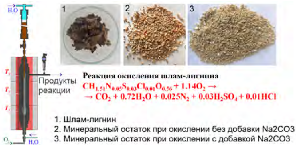
Рисунок 53 – Одностадийный способ полной утилизации отходов целлюлозно-бумажной промышленности с добавкой Na 2 CO 3
