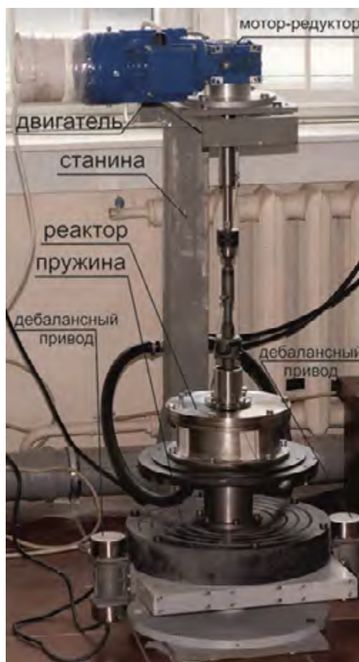
Рисунок 50 – Волновой модернизированный смеситель
