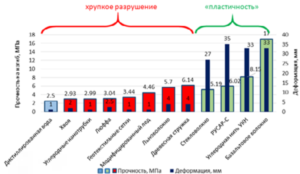
Рисунок 173 – Прочность образцов КМЛ с различными наполнителями при изгибе
