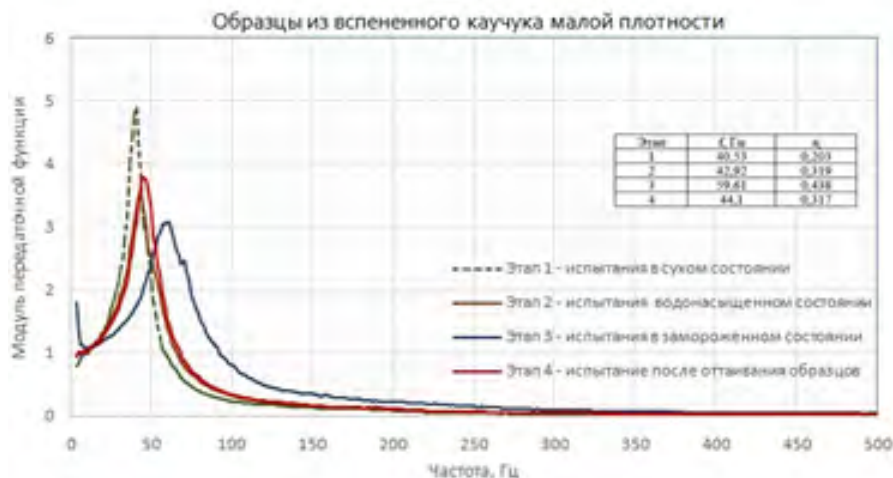
Рисунок 159 – Динамические и эксплуатационные характеристики вибродемпфирующих материалов, выполненных из эластомерных материалов
