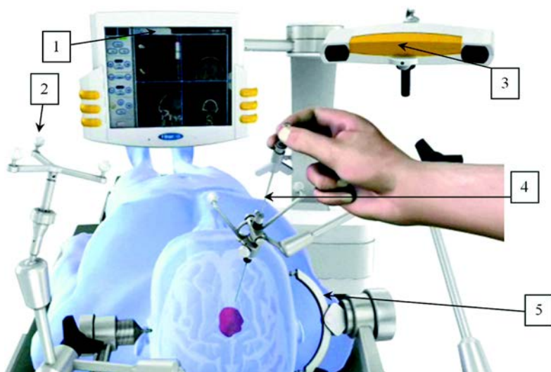
Рис. 6-1. 1 – интраоперационный монитор, 2 – маркеры СК, связанной с подголовником, 3 – оптический датчик диджитайзера, 4 – стереотаксический инструмент с маркерами, 5 – скоба типа Mayfield для фиксации головы.
