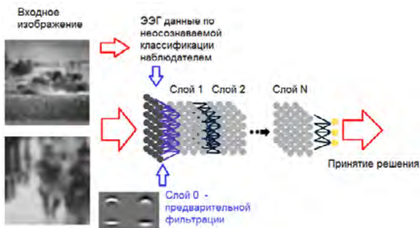
Рис. 88. Передача нечеткого изображения на многоуровневую нейронную сеть
