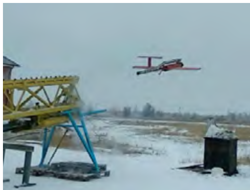
Рис. 69. Первый в мире дозвуковой полет беспилотного летательного аппарата с прямоточным двигателем нового типа
