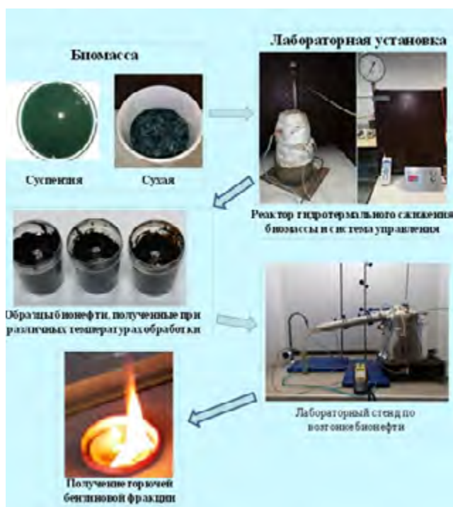
Рис. 38. Получение бионефти из биомассы микроводорослей
