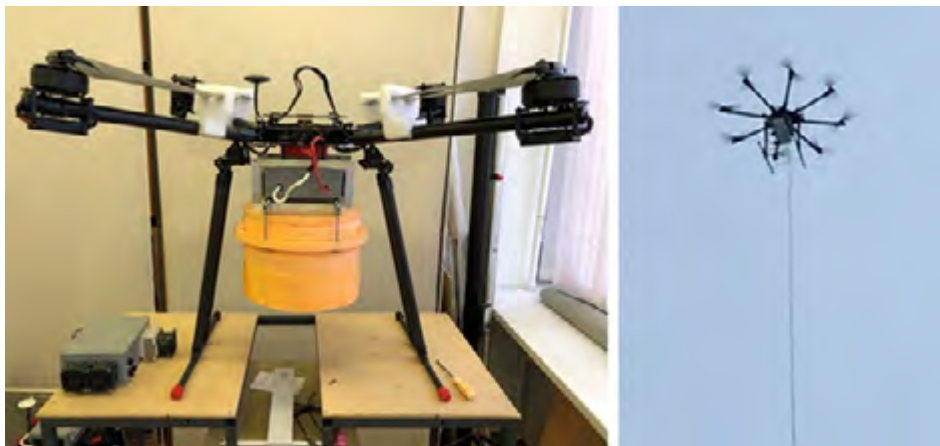
Рис. 41. Привязная высотная телекоммуникационная платформа
