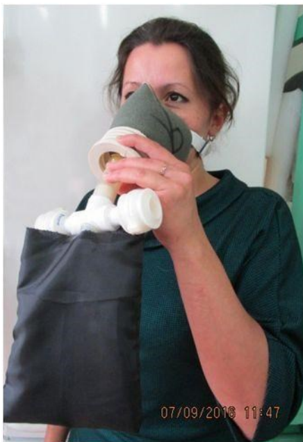
Рисунок 3. Устройство для сбора микрокапель легочной жидкости из выдыхаемого воздуха, созданное на основе разработанного фильтрополотна.
