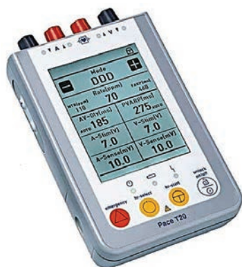
Рис. 57. Наружный (временный) электрокардиостимулятор.
