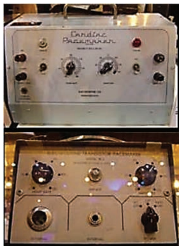
Рис. 56. Электрокардиостимулятор – разработка John H. Hopps.
