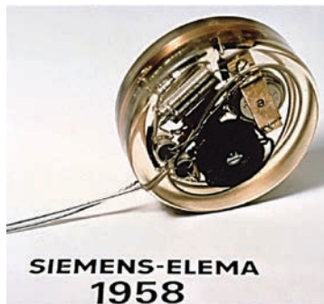
Рис. 58. Первый имплантируемый кардиостимулятор.
