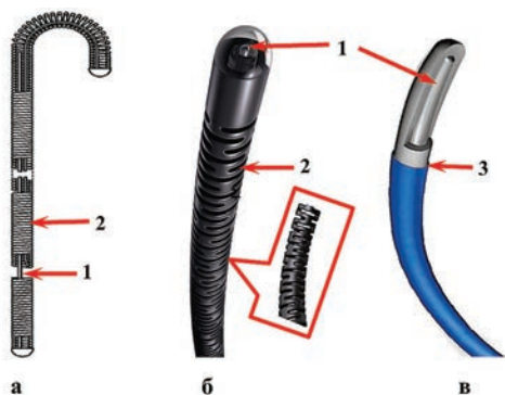
Рис. 7. Строение проводников: а) металлический проводник (сердечник – сталь или нитинол) с обмоткой вокруг жесткого сердечника; б) металлический проводник (сердечник – нитинол и оплетка из нитинола в виде трубки с поперечными прорезями; в) металлический (сердечник – нитинол) и пластиковый внешний чехол; 1 – металлический сердечник (ядро); 2 – наружное плетение (оболочка); 3 – полимер.
