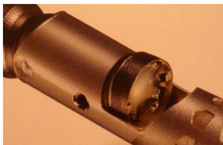
Рис. 18. Режущий элемент из высокоуглеродистой стали; скорость вращения до 8000 об/мин.
