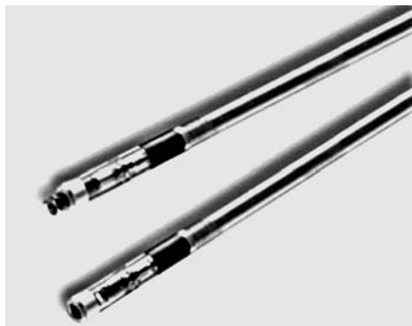
Рис. 8. Эндокардиальный электрод с активным механизмом фиксации (extendible helix): фиксация осуществляется путем вращения спирали, которая при этом выдвигается из канала электрода.
