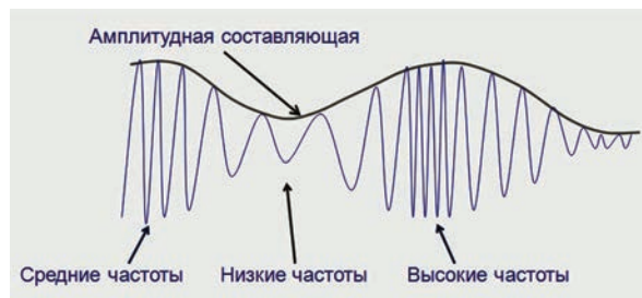
Рис. 14. Амплитудная и частотная составляющие ультразвукового сигнала.
