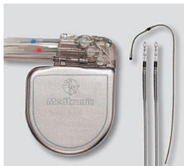
Рис. 61. Трехкамерный ЭКС и электроды к нему.
