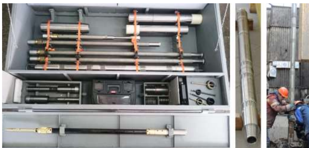
Рисунок 26 – первая отечественная телеметрическая система каротажа в процессе бурения
